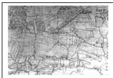
Рис. 25. Структура сплава, содержащего 95 % Ag
